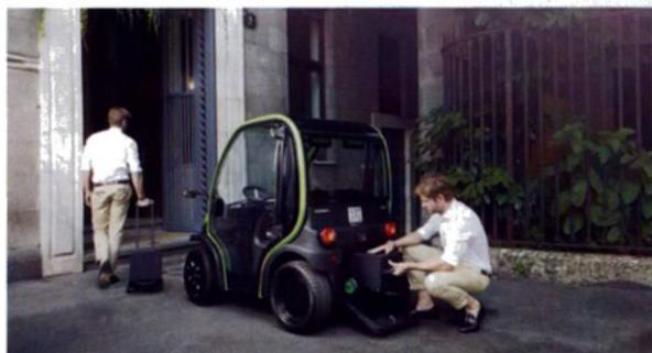
nuova batteria al litio di Birò, il piccolo *personal commuter* elettrico a 4 ruote targato Estrima. La batteria estraibile può essere trasportata come un trolley così da poter essere collegata e messa in carica nella presa di corrente più vicina. *Re-move* è estremamente ergonomica e maneggevole: misura 28 x 26 cm e pesa solo 26 kg.
