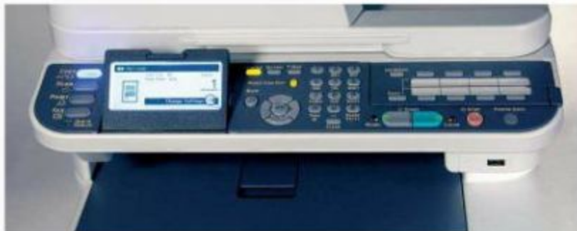
Il pannello di controllo si basa su un ampio display a cristalli liquidi monocromatico e una serie di pulsanti
