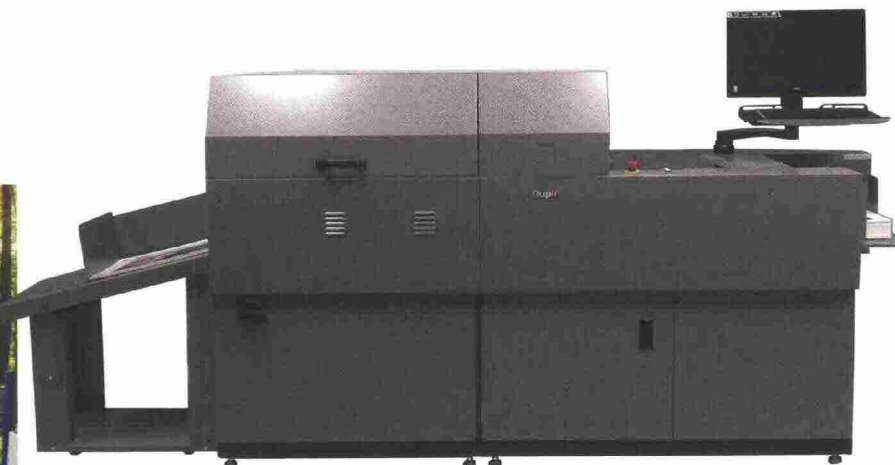
A lato. Il verniciatore UV Spot DuSense DDC-810 marchiato Duplo è già stato installato presso numerosi stampatori.
