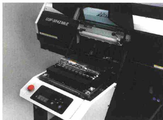
L'opzione Kebab di Mimaki consente di stampare direttamente su oggetti cilindrici
