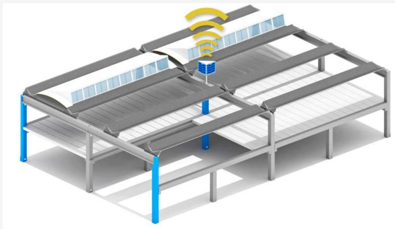
Questo sistema di monitoraggio è del tutto **integrato** negli edifici prefabbricati. Esso viene integrato, durante le fasi di produzione, direttamente all’interno dei pilastri prefabbricati principali. Nella struttura viene integrato un **complesso di sensori** per rilevare i dati relativi alle caratteristiche termo-igrometriche interne dell’edificio. I sensori rilevano anche le variazioni dovute alle sollecitazioni dinamiche cui viene sottoposta la costruzione.
