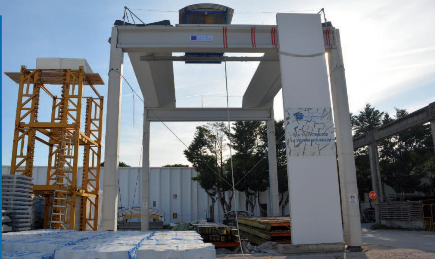
**IL PRIMO IN EUROPA** Il primo simulatore di terremoti privato per strutture prefabbricate in Europa (sopra). È in grado di riprodurre gli effetti di una scossa di terremoto per poter testare gli effetti sui prefabbricati in scala 1:1.
