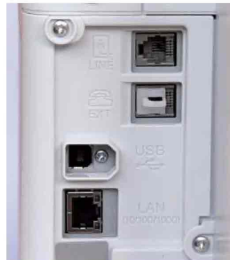
Sul pannello posteriore, oltre alla classica presa telefonica per il fax, troviamo una porta USB e una Ethernet
