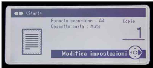
Il pannello di controllo si basa su un display orientabile da 3,5 pollici
